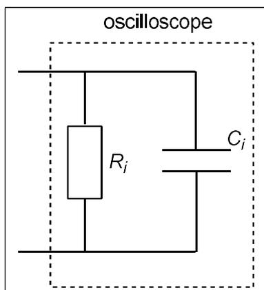
Figure 8 : modélisation de l'oscilloscope
